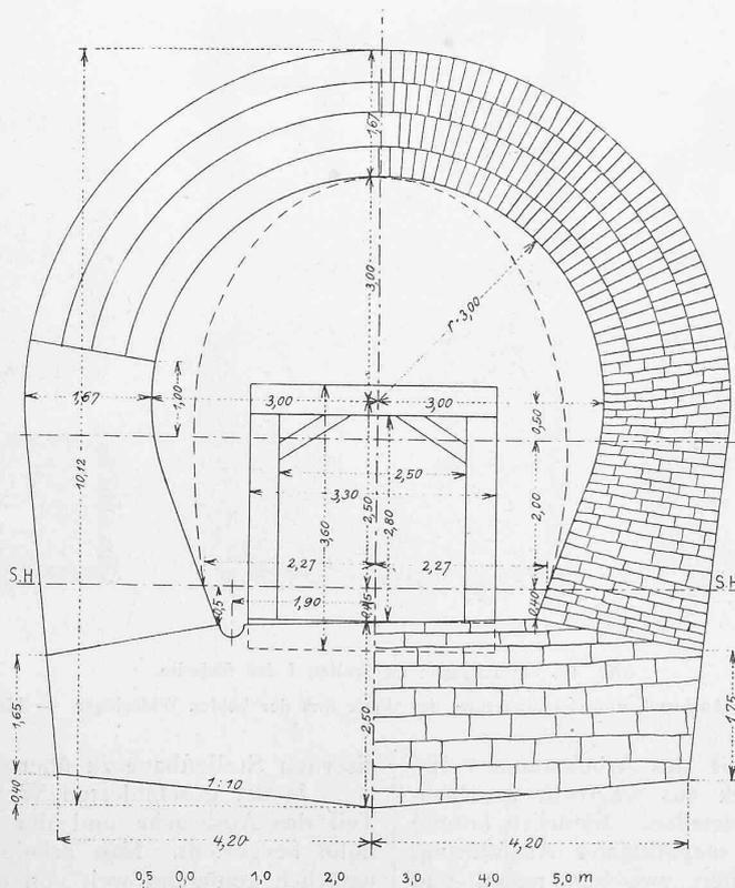
Abb. 44. Mauerungsprofil in der Druckpartie der Südseite. — 1 : 100.
