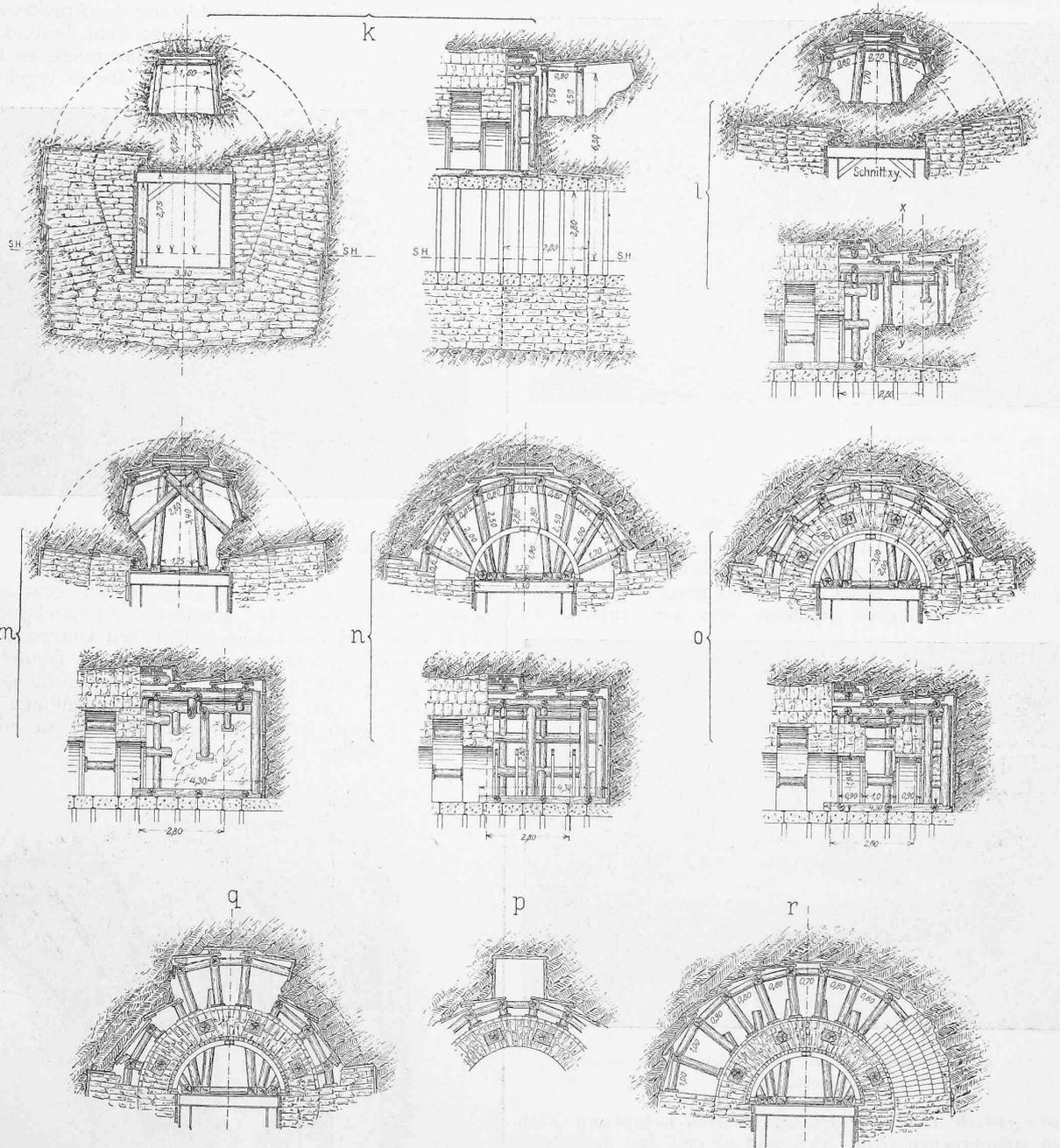
Abb. 47. Druckpartie im Stollen I der Südseite. Arbeitsvorgang bei Ausbruch und bei Mauerung der Calotte. — Masstab 1 : 200.
