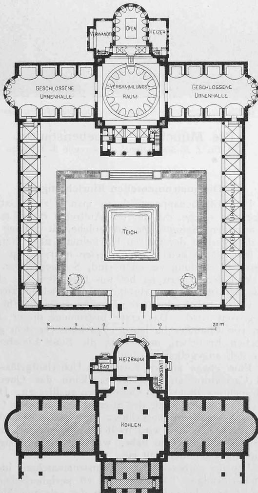
Grundrisse vom Untergeschoss und Erdgeschoss. — Masstab 1 : 600.
