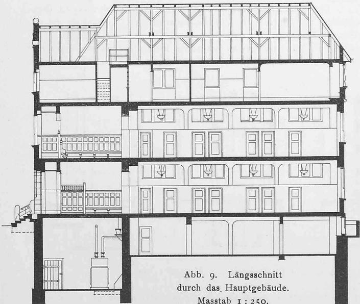
Abb. 9. Längsschnitt durch das Hauptgebäude.
