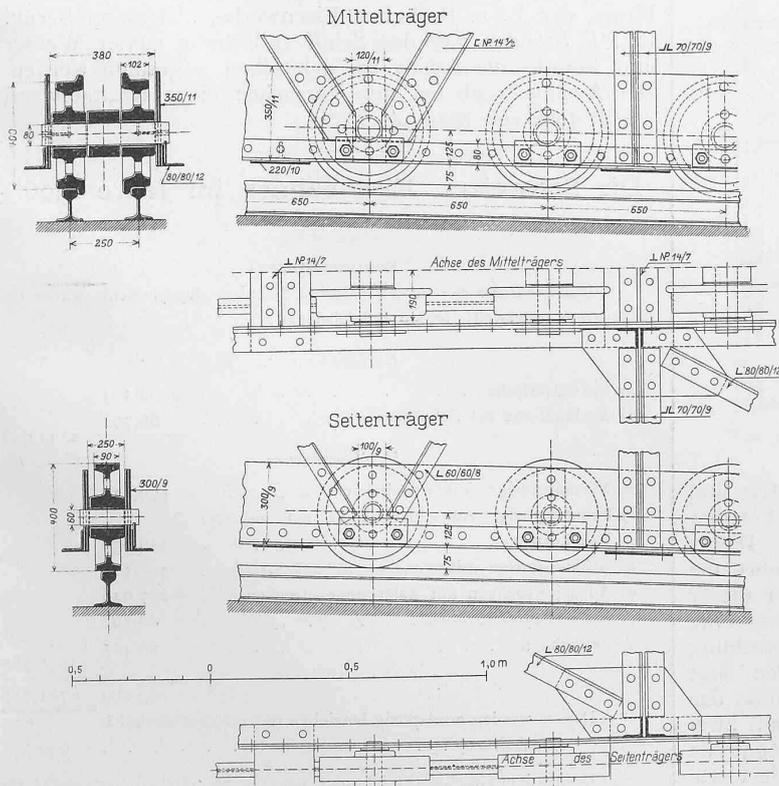
Abb. 5. Rollenlagerung. — Masstab 1 : 50.
