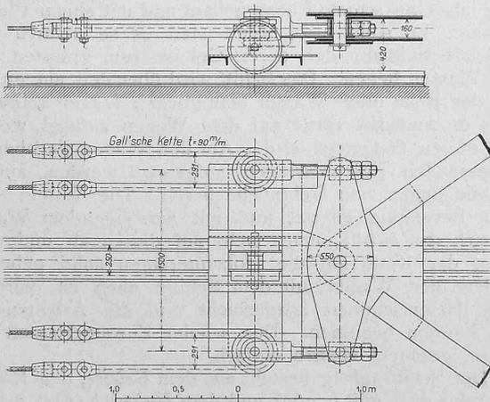
Abb. 6. Befestigung der Zugseile. — Masstab 1:50.
