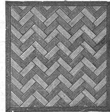
**Auf Blindboden aufgeschraubt; auf Zementbeton in Mörtel verlegt.**
