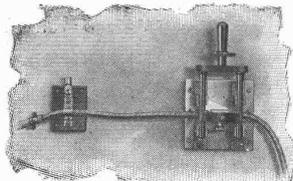
Laboratoriums-Belastungswiderstand für Spannungen bis 600 Volt und 130 Amp. Maximal-Stromstärke.
