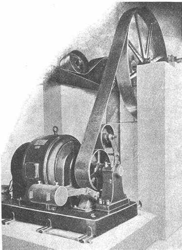
Wir liefern die Lenix-Spannrollen-Apparate in Normal-Ausführungen, an jedem Elektromotor, auch an bestehenden, anwendbar; für vertikale, schräge und horizontale Riementriebe.
