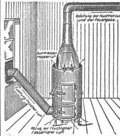
**Vorteile:** In wenigen Tagen gründliches Ausströmen schädlicher Gase. Vollkommene Erhärtung des noch frischen Verputzes, einfache nicht ständige Ueberwachung bei Tag und Nacht; mehrjährige Gebrauchsfähigkeit; leichte Ersetzbarkeit der dem Feuer ausgesetzten Teile. Beste Ausnützung des Koksmaterials. In 24 Stunden nur 1 bis 1½ Zentner Koks nötig. Ein Ofen für 100 cbm Raum. Zu beziehen à Fr. 100.— ab München durch
