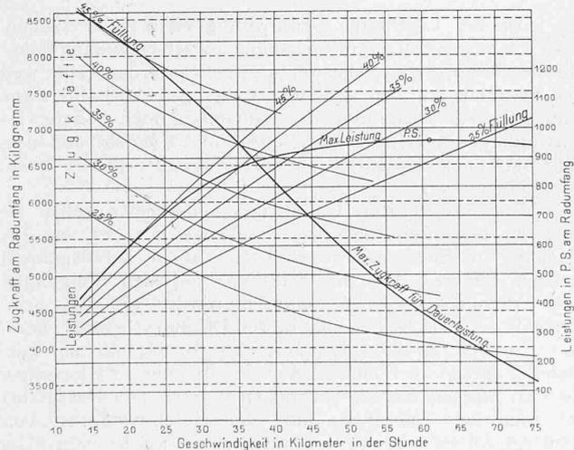
Abb. 2. Zugkräfte und Leistungen bei 25<sup>0</sup>/<sub>100</sub> bis 45<sup>0</sup>/<sub>100</sub> Füllung und 15 bis 45 km/std.
