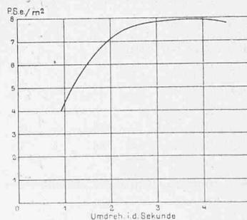
Abb. 3. Kesselbeanspruchung der B<sup>3</sup>/<sub>4</sub> H. D.-Lokomotive der S. B. B.
