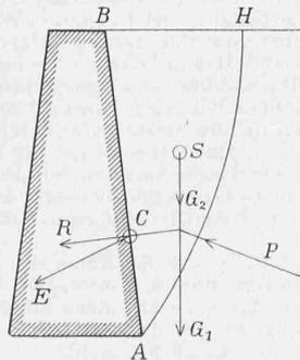
einer durch den Fusspunkt A gehenden Kurve AH gebildet wird. Die Unzulässigkeit dieser Annahme ergibt sich aus den Bedingungen des Gleichgewichtes des Erdkörpers ABH. Der durch den Punkt C gehende Wanddruck E resultiert aus dem Erddruck P gegen die Fläche AH und dem Gewichte G des Erdkörpers ABH. Die Flächenelemente ds der Fläche AH nehmen Normaldrücke auf:
