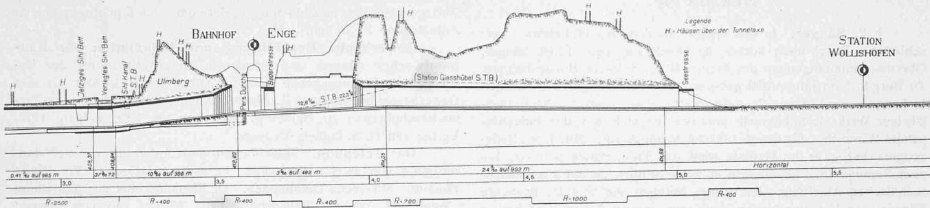
Abb. 4. Längsprofil Wiedikon-Enge-Wollishofen. — Masstab 1:15000 für die Längen, 1:1500 für die Höhen.<sup>1)</sup>
