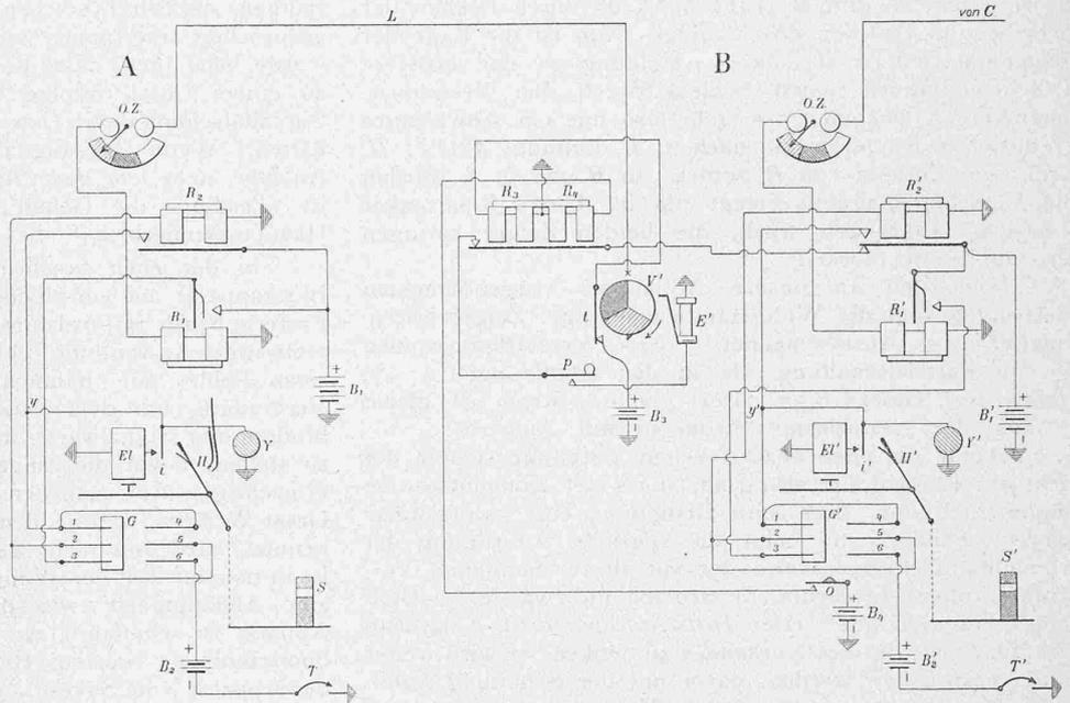
Abb. 10. Stromlaufschema des Apparates von Firth und Leake.
