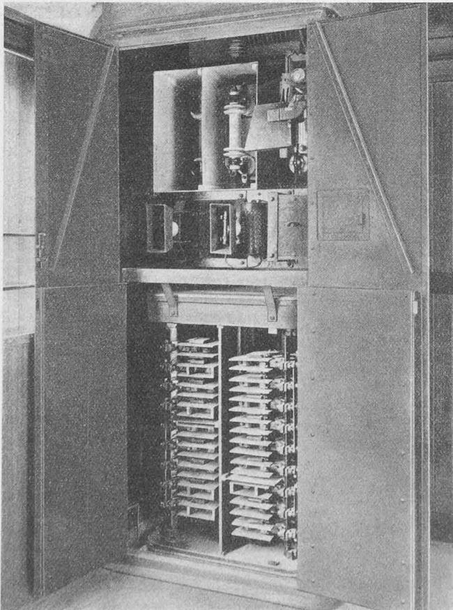
Abb. 18. Hochspannungskammer mit Kontroller des Motorwagens.
