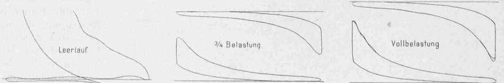
Abb. 44. Indikator-Diagramme des 25 PS-Gasmotors mit Füllungsregelung der S. L. M. Winterthur.
