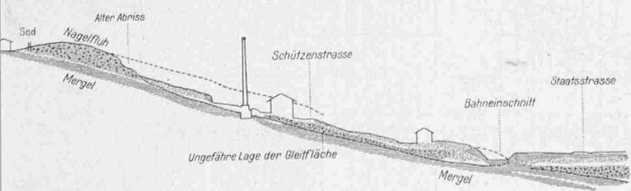
Abb. 12. Geologisches Profil der Nordhalde bei Herisau. Masstab 1 : 2500.
