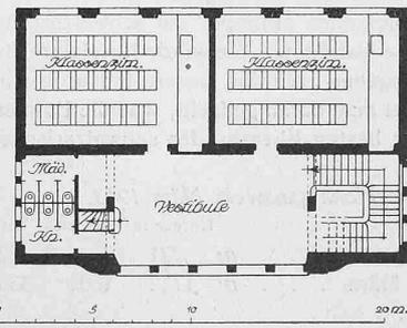
Abb. 1 und 2. Grundrisse vom Erdgeschoss und Obergeschoss. — 1 : 400.
