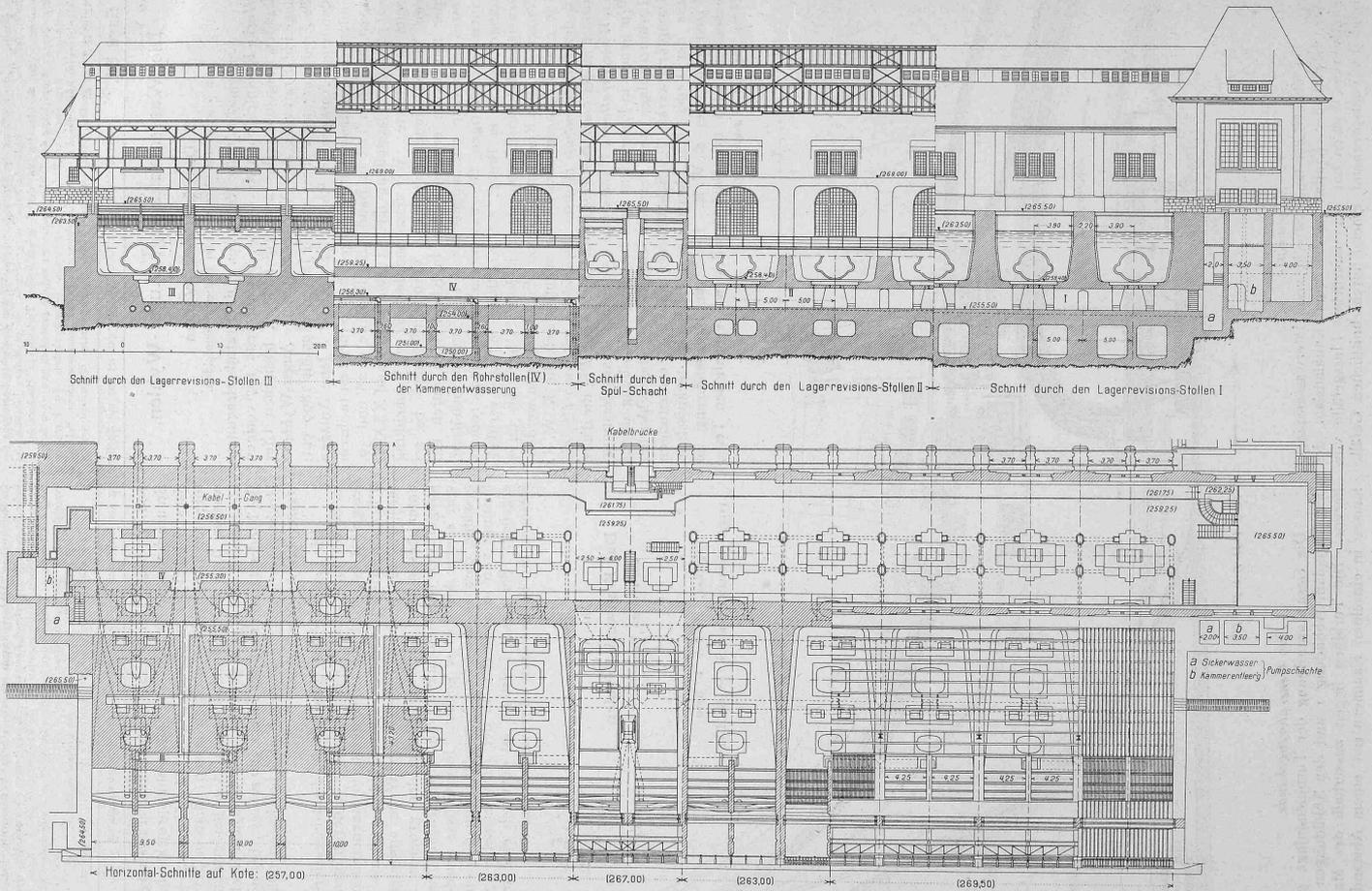
Abb. 3: Grundriss, bzw. Horizontalschnitte, und Abb. 4: Vertikale Längsschnitte des Generatorengebäudes im Wasserkraftwerk Wyhlen. — Masstab 1 : 500.
