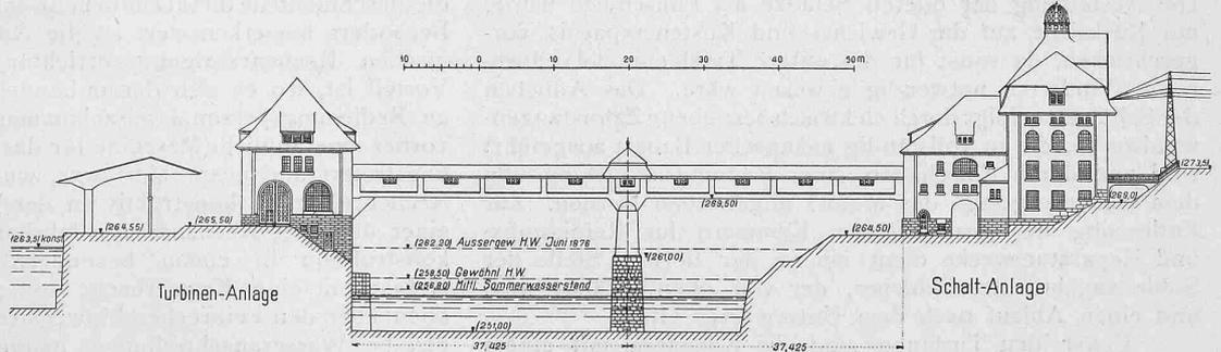
Abb. 2. Anordnung der Turbinen- und der Schaltanlage des Kraftwerks Wyhlen. — Querschnitt 1 : 1000.
