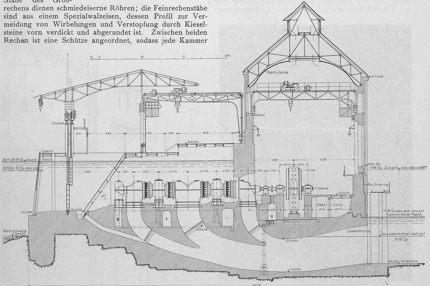
Abb. 5. Querschnitt des Generatorengebäudes mit den Turbinenkammern. — Masstab 1 : 250.
