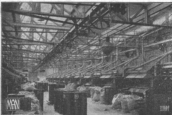
Absaugungs-Anlage für Karderie. S. A. Linière La Liève, Gent (Belgien)
