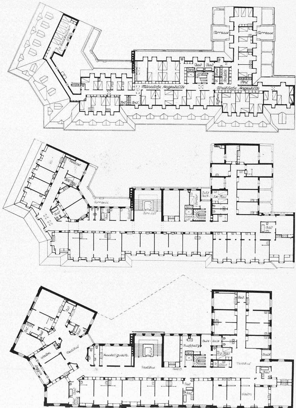
Abb. 8 bis 10. Grundrisse. — 1 : 500. — Unten: I. u. II. Wohngeschoss; Mitte: IV. Wohngeschoss [I. Dachstock]; Oben: Angestellten-Zimmer [II. Dachstock].
