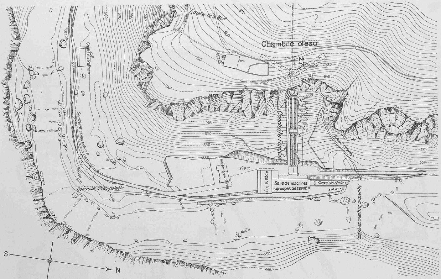
Abb. 10. Lageplan des Wasserschlosses, der Druckleitung und der Zentrale (letztere im ersten Ausbau). — Masstab 1:2500. (Photographische Verkleinerung des französisch beschrifteten Originalplans.)
