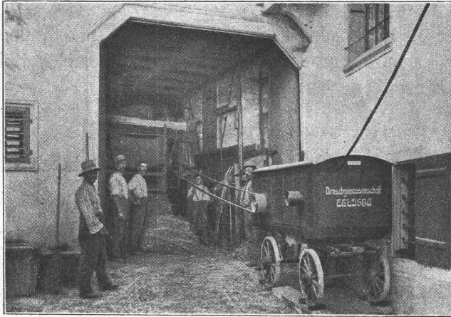
Dreschmaschinenantrieb mit Oerlikonmotor.
