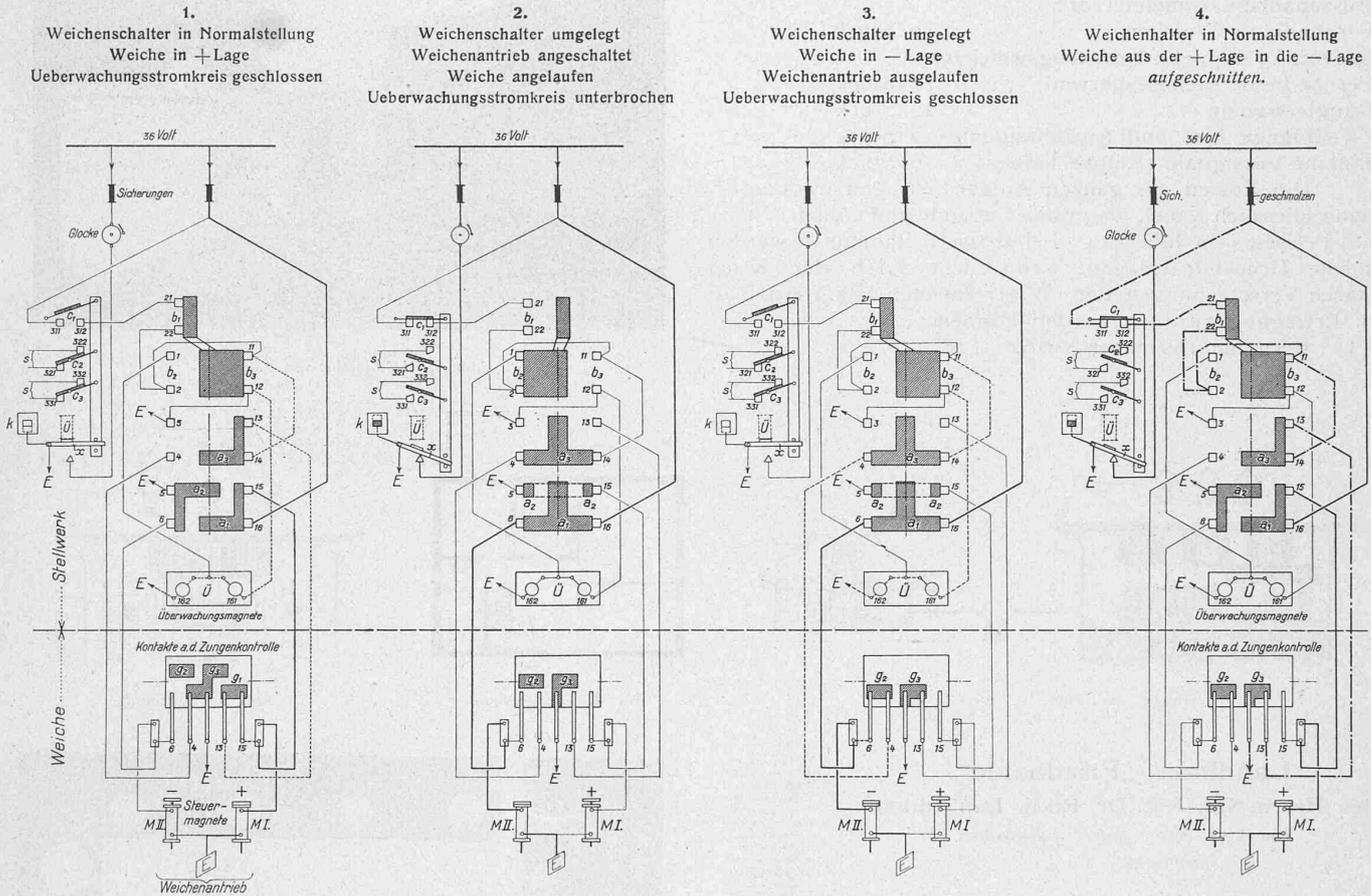
Abb. 17. Schaltungsschema für den Weichenschalter und den Druckluftantrieb einer einfachen Weiche.
