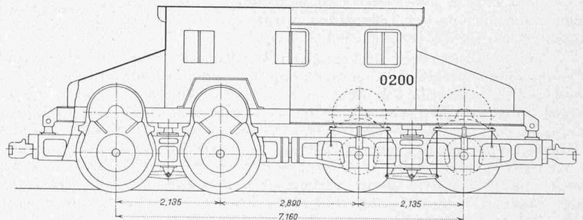
Abb. 10. Rangierlokomotive von  $4 \times 125$  PS Stundenleistung. — 1 : 100.
