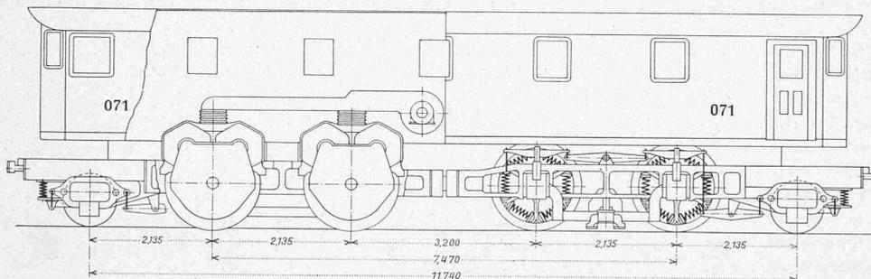
Abb. 9. Güterzuglokomotive von  $8 \times 175$  PS Stundenleistung, Totalgewicht 110 t. — 1 : 100.
