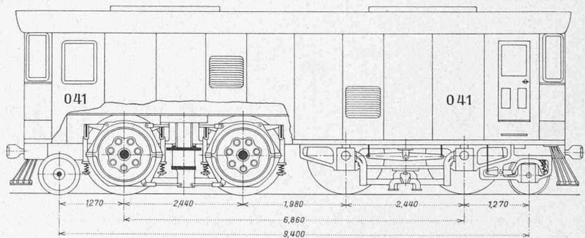
Abb. 8. Personenzug-Lokomotive für Einphasen-Wechselstrom. — 1 : 100.
