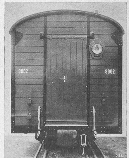
Abb. 2. Stirnwand ohne Plattform mit Doppeltüre des Hilfswagens der Rhätischen Bahn.
