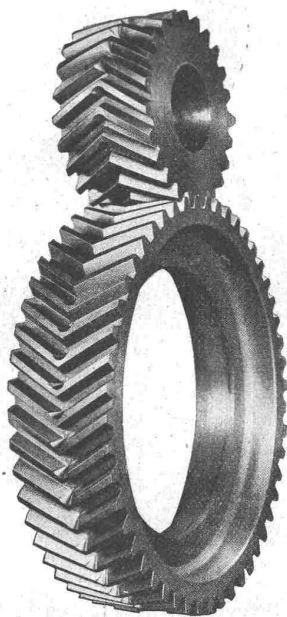
Figur 5. Pfeilradgetriebe der Jungfraubahn. Gehobelte Maag-Verzahnung.
