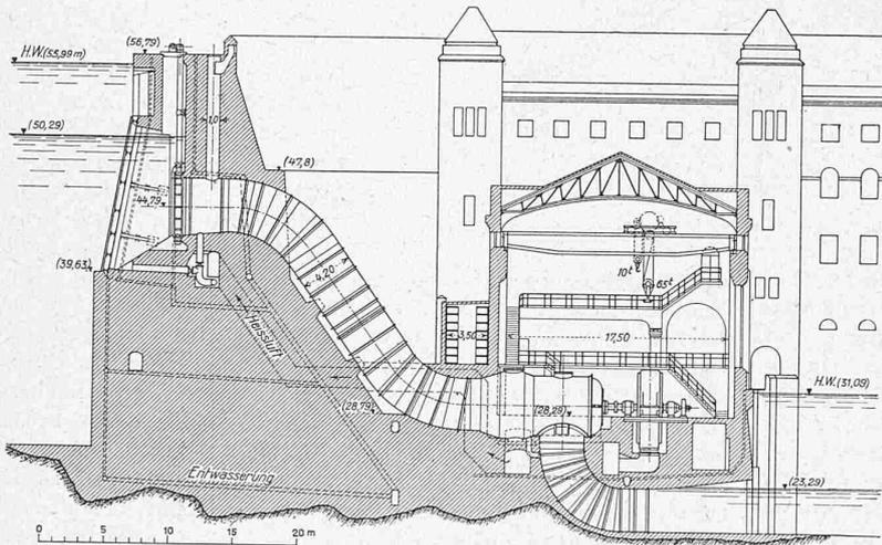
Abb. 2. Querschnitt durch Stauwehr und Maschinenhaus. — Masstab 1:600.
