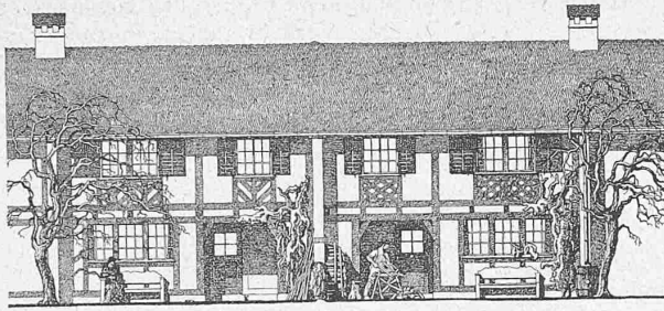
Abb. 28. Sonnenseite, mit sichtbarem Riegelwerk. — 1:200.
