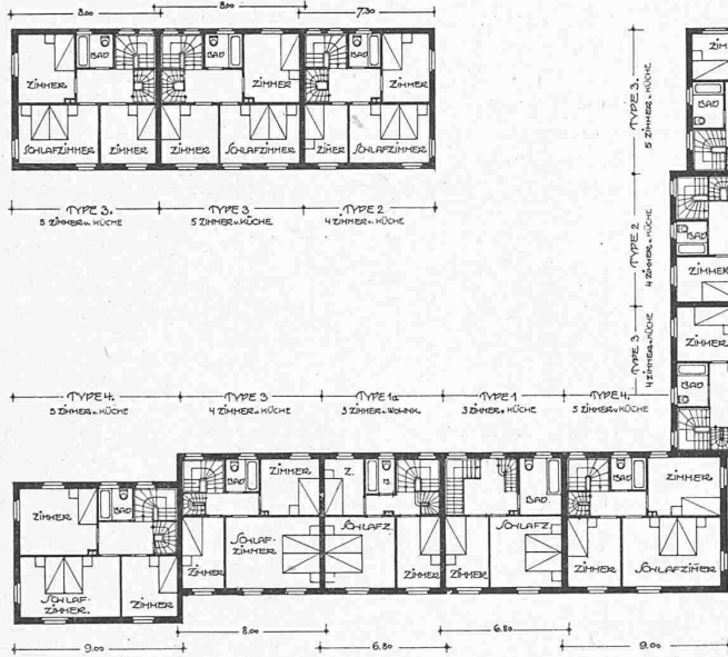
Abb. 42. Baublöcke 5 (oben) und 6. — Obergeschoss 1:400.
