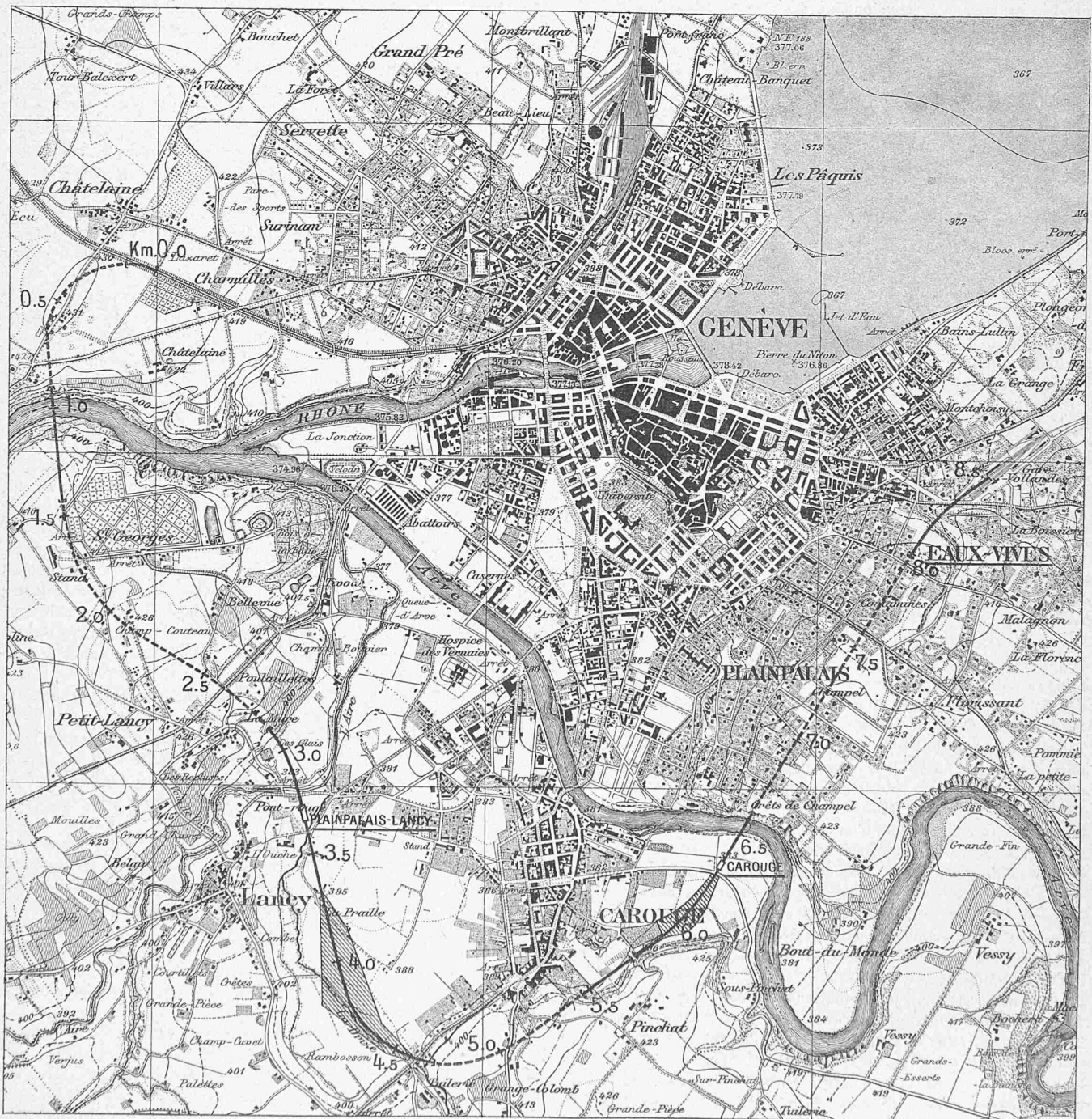
Fig. 1. Plan de la ville de Genève avec tracé du raccordement Cornavin-Eaux Vives suivant l'avant-projet du 7 mai 1912. — 1 : 25 000.
