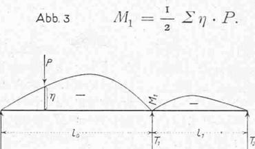
Die graphische Ermittlung der Kurvenpunkte geht aus der Abbildung 2 hervor. Ganz analog werden die Punkte für das Teilstück der Einflusslinie über der Oeffnung  $l_1$  bestimmt.
