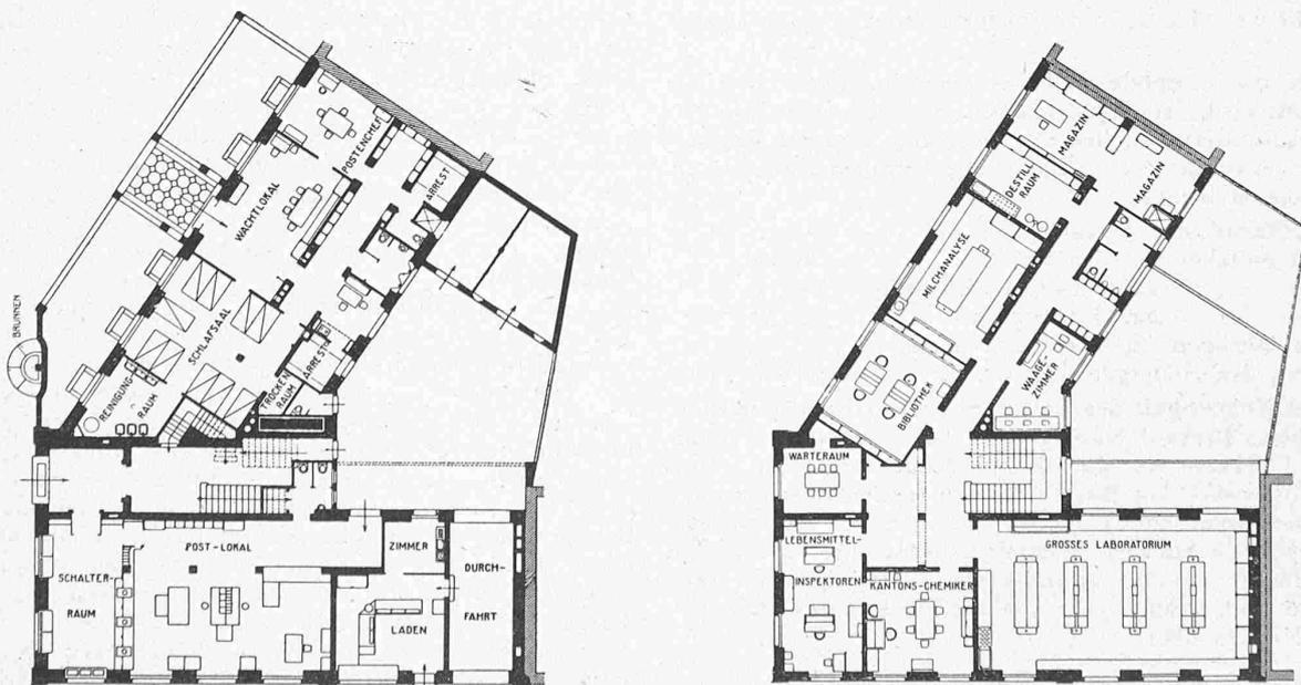
Abb. 3 und 4. Grundrisse vom Erdgeschoss (Post und Polizei) und I. Stock (Lebensmittel-Kontrolle). — 1:400.
