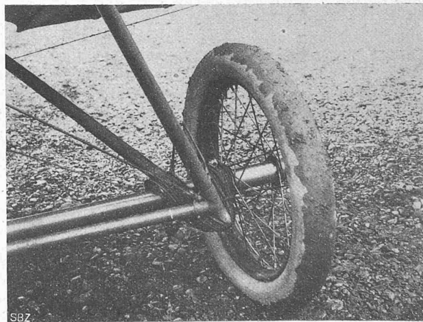
Abb. 10. Abfederung der Radachse mittels Gummibändern.
