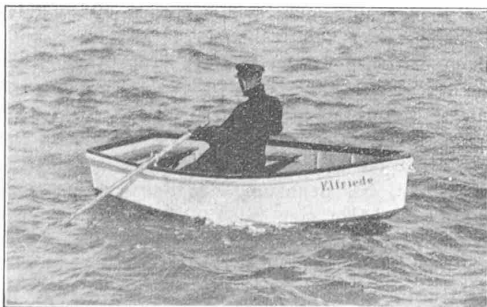
Abb. 1. Kleines Ruder- und Beiboot aus Duralumin.
