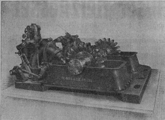
Doppel-Pelton-Turbine für 8000 PS Leistung bei 200 m Gefälle und
