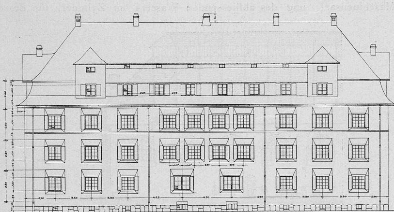
Abb. 3 und 4. Bahnseitige Fassade und halbe Strassenfassade. 1:300. — Erbaut 1914 durch das Hochbaubureau der Rh. B., Arch. M. Lorenz.
