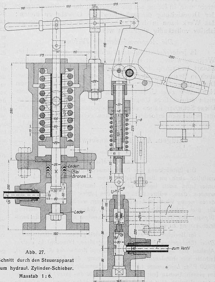
Abb. 27. Schnitt durch den Steuerapparat zum hydraul. Zylinder-Schieber. Masstab 1:6.
