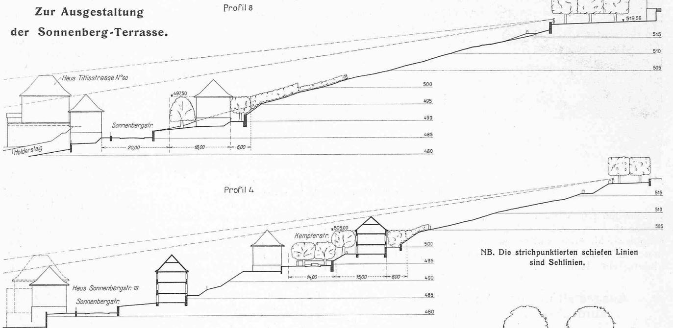
Abb. 3. Profile 4 und 8 zum Lageplan in Abb. 2. — Masstab 1 : 1000.
