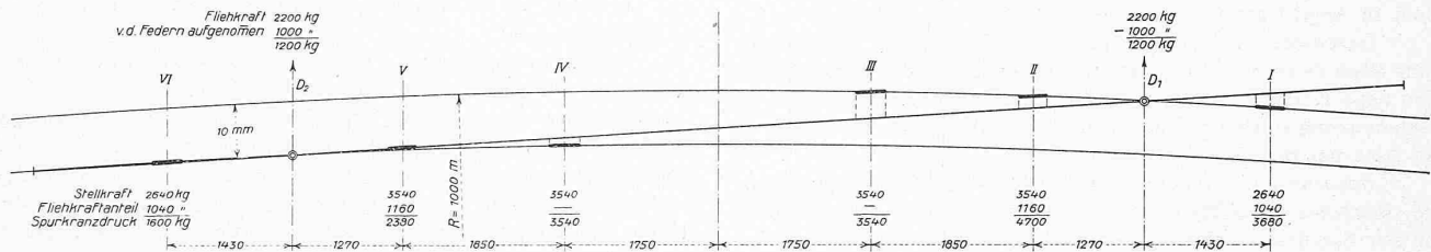
Abb. 30. Kurveneinstellung einer Lokomotive mit Achsfolge nach Abb. 25 und Drehgestellen nach Abb. 27.
