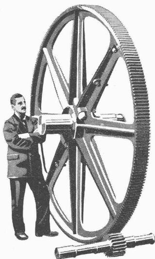
Ritzel mit gehärteten und geschliffenen Zähnen
