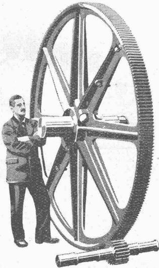
Ritzel mit gehärteten und geschliffenen Zähnen
