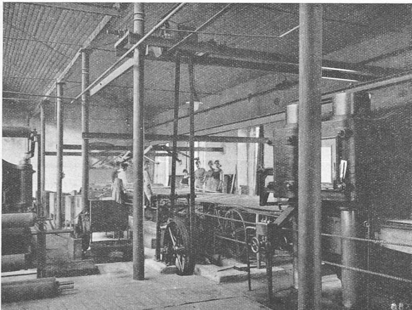
Abb. 7. Raum für Inlaid-Fabrikation. Rechts eine der hydraulischen Pressen.
