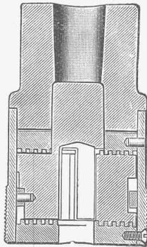
Hält jeden zylindrischen Bohrer beliebiger Stärke garantiert fest. Erübrigt die Verwendung von Konusbohrern und Reduzierhülsen. Leichtes Handhaben beim Ein- und Ausspannen (auch bei laufender Maschine).
