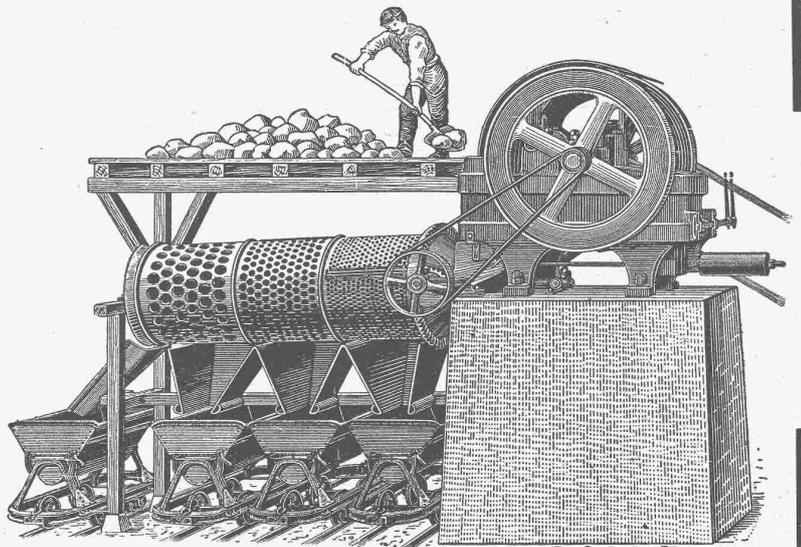
Steinbrecher mit Sortiertrommel.
