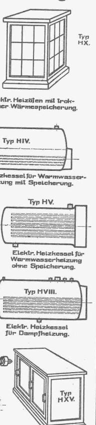
Elektr. Heizöfen mit trockener Wärmespeicherung.
