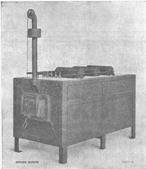
Elektrischer Glühofen Bauart Brown Boveri Nutzbarer Glühraum 1800 × 500 × 300 mm
