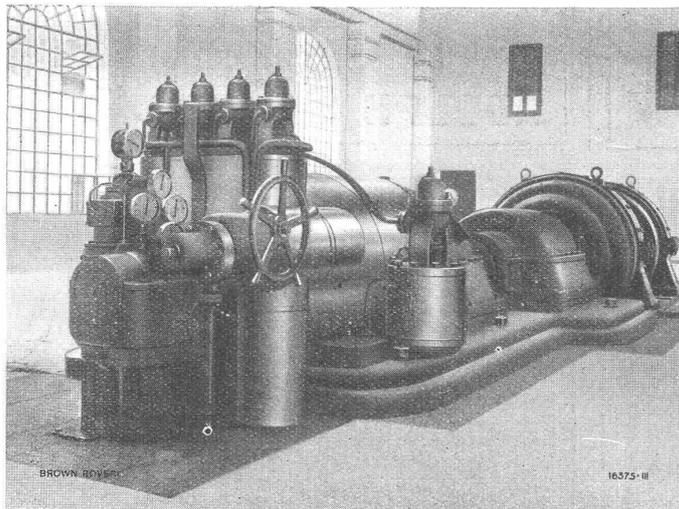
Gleichstrom-Anzapf-Turboaggregat, 2500 kW Leistung, Drehzahl 3000/750,
