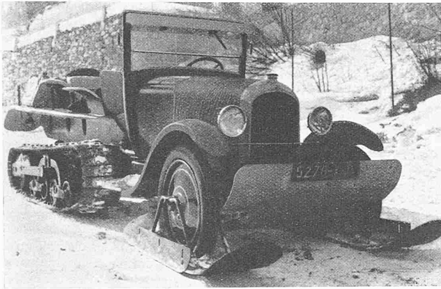
Abb. 1. Citroën-Automobil mit Raupenbandantrieb und Kufen.
