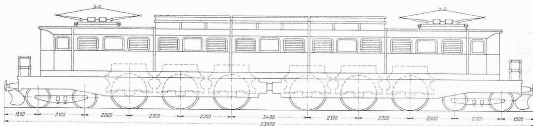
2 C<sub>0</sub> C<sub>0</sub> 2 Gleichstrom-Schnellzuglokomotive von 5400 PS Stundenleistung bei 72 km/h mit „Oerlikon“-Einzelachsantrieb (max. 130 km/h) für die Paris-Lyon-Mittelmeer-Bahn. — Masstab 1 : 150.
