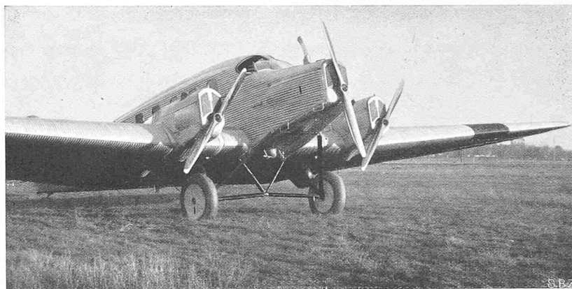
Abb. 15. Junkers G 24 wie oben, 3 \times 280/310 PS, Sp W 28,5 m, L 15,2 m, G = 4300 + 2200 kg, 200 km/h, 9 Passagiere. Deutsche Lufthansa. Zürich-Stuttgart-Berlin, Genf-Basel-Frankfurt-Hamburg.
