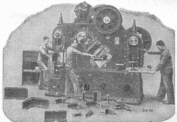
Blech-, Profileisen- u. Gehrungsschere mit Universal-Loch- u. Ausklink-Maschine
