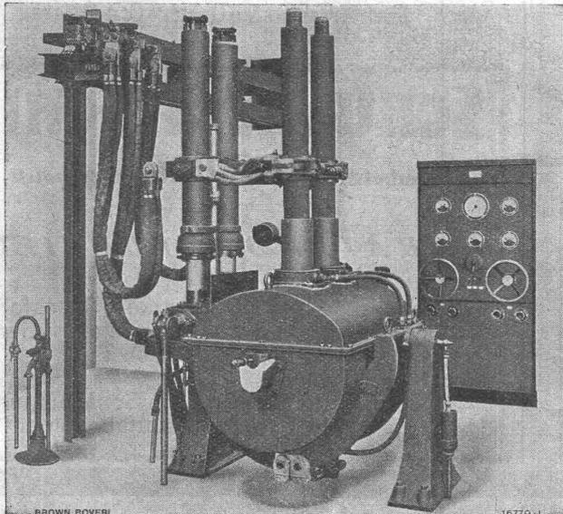
Elektrischer Metallschmelzofen für Dreiphasenstrom,
