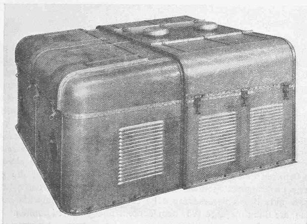
Abb. 2. Aus Aluminium-Legierungen ausgeführte Vorhaube obiger Lokomotiven.
