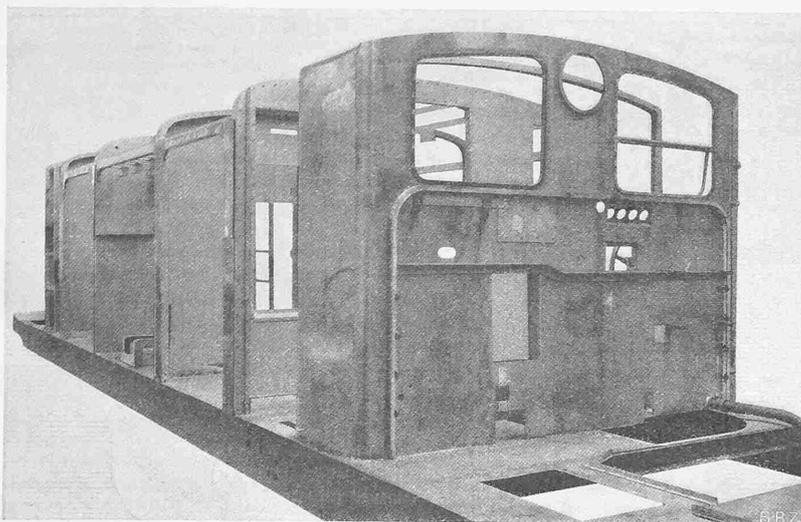
Abb. 1. Kastengerippe aus Anticorodal der Lokomotive der Visp-Zermatt-Bahn.
