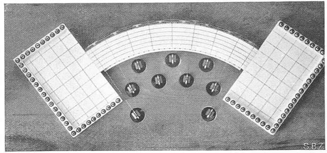
Abb. 6. Horizontalscheibe eines Talsperrengewölbes, theoret. Spannweite 52 cm.
