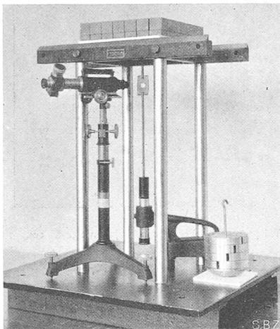
Abb. 7. Gestell für Plattenmodelle; I. Höhe 55 cm.
