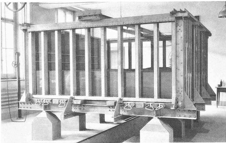
Abb. 9. Sandbehälter für Erddruckversuche, Grundfläche rund 3 × 3 m.
