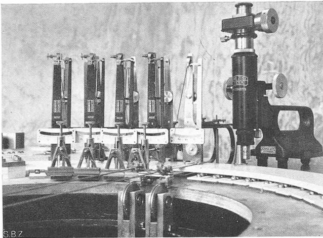
Abb. 5. Ausmessung eines Gewölbemodells mit Tensometern Huggenberger.
