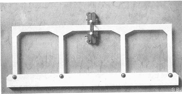
Abb. 2. Modell eines durchlaufenden Rahmens, theoretische Höhe 15 cm.
